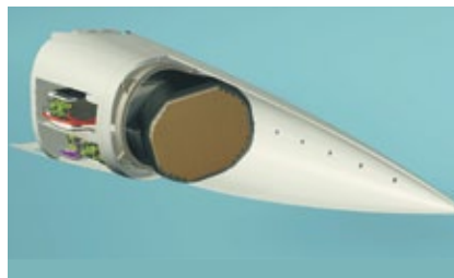
The Selex Galileo Vixen 1000ES AESA radar.
